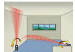
FUNZIONE "TRACKING" distanza minima - massima
