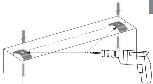
Forare con punta da 6mm il vano superiore così come indicato in figura, mantenendo l'allineamento, posizionare le clip e fissare con le viti.
